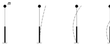
Рис.2 – Розрахункова схема та три власні форми коливань баштових споруд
