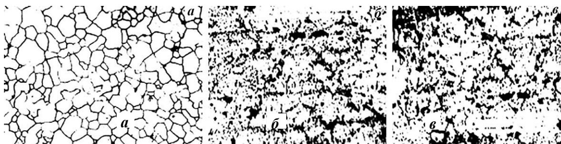
Рис. 5 – Мікроавторадіограми заліза ( ^{55}\text{Fe} ) після УЗ обробки з нагрівом ( \varepsilon_m = 1,3 \cdot 10^{-4} , T = 773 \text{ K} ), \times 70 , та заліза після дифузії в нього вуглецю ^{14}\text{C} при нагріві ( a ) та нагріві з ультразвуком ( б ) ( 1073 \text{ K} , 30 \text{ кГц} ), \times 150 .
