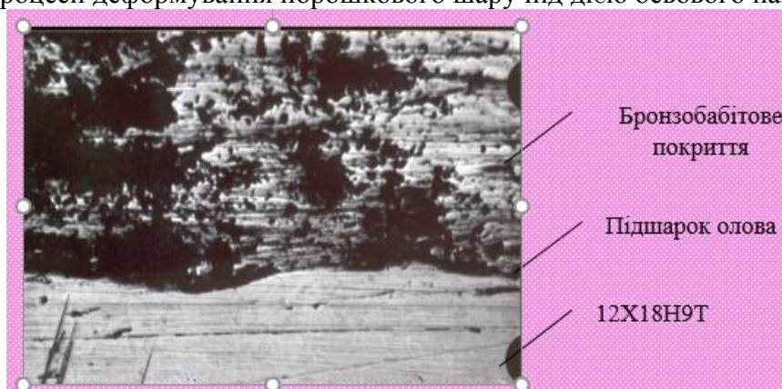
Рис. 1 – Оптична мікрофотографія ( \times 150 ) дослідного біметалевого зразку
