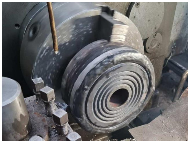
Рис. 3 – Механічна обробка пресової шайби на токарному верстаті
