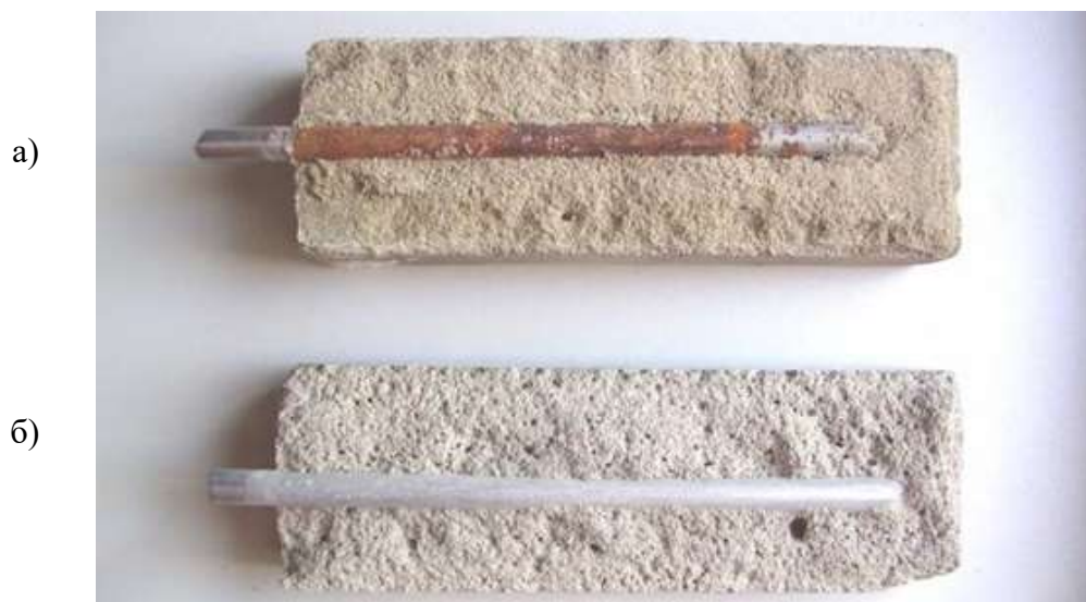
Рис. 1 – Дослідження антикорозійних властивостей інгібіторної суміші: а) без просочення; б) з просоченням МІК [5].
